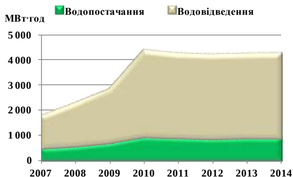
Рисунок 3.4 Споживання електричної енергії на водопостачання та водовідведення
