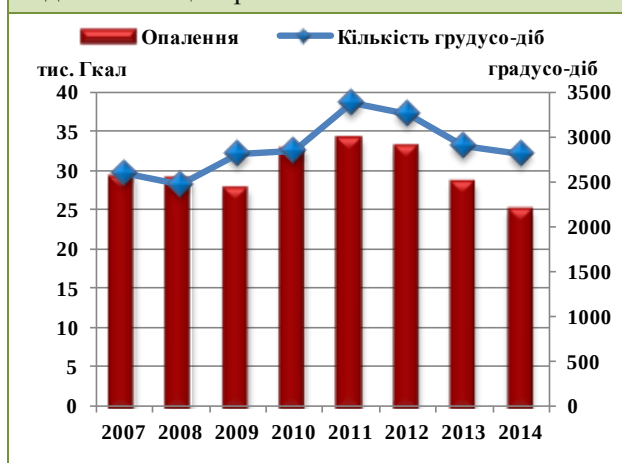
Рисунок 2.2.2. Споживання теплової енергії від системи централізованого теплопостачання
